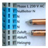
Verbinden Sie die Phase des 230 Volt Netzes mit dem Anschluss *Phase L 230 V AC* (grau), den Nullleiter mit dem Anschluss *Nullleiter N* (blau) und die Erde mit dem Anschluss *Erde PE* (orange). Sie können auch ein Netzkabel verwenden. Sie müssen jedoch gewährleisten, dass sich dann die Phase auch auf dem Phasenanschluss der Steuerung befindet. Falls nicht, erkennt das die Steuerung und fordert
